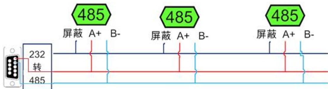
电脑自带的串口一般是 RS232，需要配 232-485 转换器（工业环境建议使用有源带隔离的转换器），转换后 RS485 为 A、B 两线，A 接板上 A 端子，B 接板上 B 端子。若设备比较多建议采用双绞屏蔽线，采用链型网络结构。
